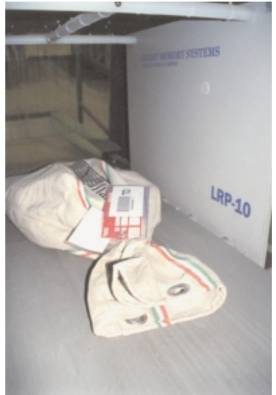
Dabei können sich die Sendungen auch gesammelt in einem Postsack befinden. Das erhöht den Durchsatz der Sendungen in den Sortier- und Umschlaganlagen und vereinfacht das Handling.
